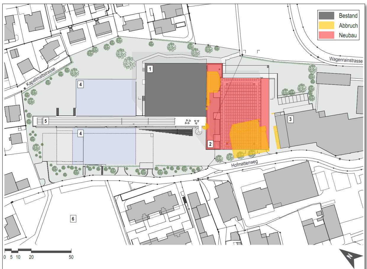
Situationsplan mit Bestand, Abbruch und Neubau
